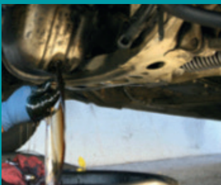
Stop de motor en tap de olie af. Laat deze goed uitlekken. Vervang het oliefilter. Demonteer de oliedruk meter weer.
